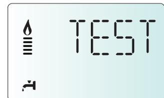
Prima di iniziare l'analisi della combustione, attendere un minuto in modo che la caldaia si stabilizzi. Rilevare il valore del CO2(%) e confrontarlo con quanto riportato nella tabella seguente:
