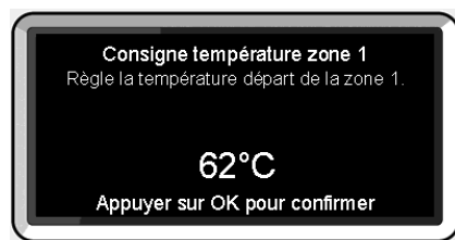
Modifier température eau chaude chauffage
