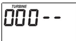
2. Le prime tre cifre indicano il flusso attraverso la turbina: "000" indica assenza di passaggio di acqua; aprire un rubinetto a valle dell'impianto e verificare che il display cambi fino ad un massimo di "199".
