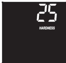
Effettuare una misura della durezza dell'acqua in ingresso e inserire il relativo valore premendo i tasti SU e GIU per aumentare o diminuire il valore. Per determinare la durezza dell'acqua, rivolgersi a un laboratorio di analisi oppure alla società che si occupa del servizio idrico locale se si è allacciati a una rete idrica municipale.
