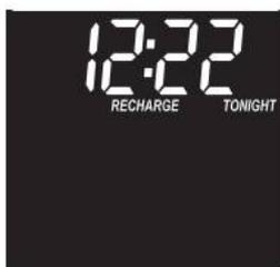
La scritta "RECHARGE TONIGHT" lampeggia sul display e l'addolcitore avvierà un ciclo di rigenerazione alla prossima ora di rigenerazione. La scritta "RECHARGE NOW" lampeggerà durante la rigenerazione. terminate le operazioni l'addolcitore avrà completamente ripristinato la sua capacità di scambio.
