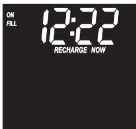
L'addolcitore inizia un ciclo completo di rigenerazione, la scritta "RECHARGE NOW" lampeggia per tutta la fase di rigenerazione. terminate le operazioni l'addolcitore avrà completamente ripristinato la sua capacità di scambio.
