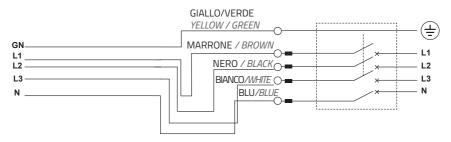
NOTA: è necessario collegare il disgiuntore termico, dei motori elettrici ad un sistema ausiliario di interruzione trifase esterno.
