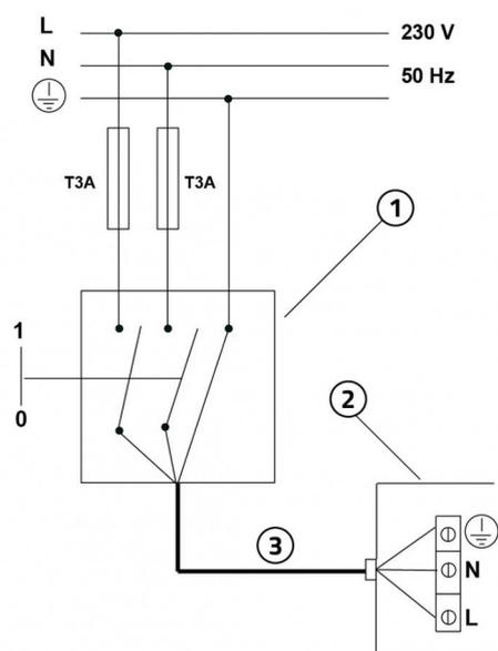
[1] Interruttore di protezione magneto-termica onnipolare conforme a EN 61508:1
