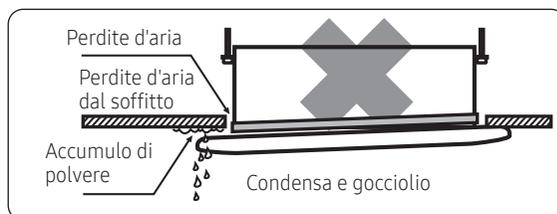
Un'eventuale installazione incompleta (fissaggio incompleto) provoca problemi, come mostrato in figura. Controllare nuovamente al termine dell'installazione.
