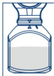
MiniDOS OTTONE è completamente auto-adescente: è sufficiente rabboccare periodicamente AcquaSIL 20/40° nel serbatoio. La pompa è protetta dalla contro-pressione della rete idraulica da valvola di non ritorno.
