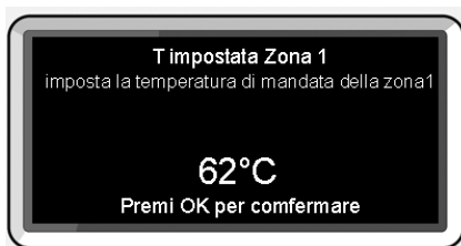
Modifica temperatura acqua calda riscaldamento
