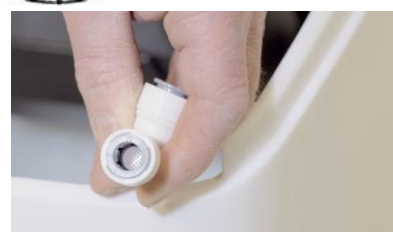
Sostituzione gomiti scarico salamoia
